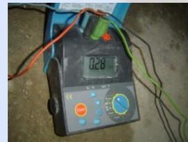
Si hay un cambio significativo entre los valores de la resistencia mayor al 10% entonces se incrementará la distancia entre el electrodo **A** y la pica **C** y se volverá a repetir el proceso.
