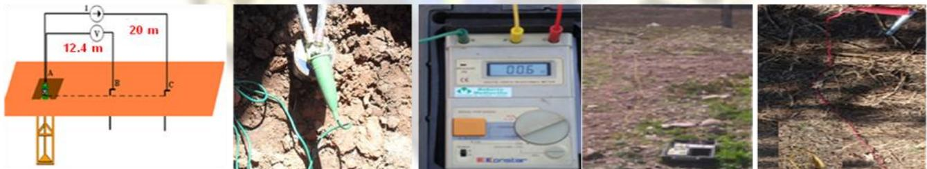
Figura 1. Método de la Caída de Potencial.
