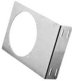
Diseñados para facilitar el montaje de los ventiladores refrigerantes Hoffman en paneles de gabinetes. Los soportes pueden usarse para circulación general del aire o para dirigir el aire a áreas problemáticas. Todos los tamaños son de aluminio de 0.100 pulg. Un soporte por paquete. Los ventiladores deben ordenarse por separado.
