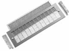
Se ubica en el lado de descarga de aire de un gabinete, utilizando un paquete de soplador ADB275. La rejilla de acero inoxidable pulido está abierta en un 65 por ciento y ofrece baja resistencia al flujo de aire. El filtro de aluminio expandido (incluido con cada rejilla) se quita fácilmente desde el exterior del gabinete para su limpieza. Se proveen los componentes para el montaje.
