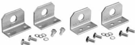
Se usan para proveer la mejor distribución de carga al levantar dos o tres gabinetes unidos con hasta 1000 lb (454 kg) de equipo y cableado en cada compartimento. Los ángulos se montan en la parte superior de los bloques de esquina del armazón del gabinete y no es necesario quitar la tapa superior para la instalación. El kit contiene dos ángulos y cuatro pernos y arandelas. Los ángulos son de acero calibre 10 chapado con cinc claro.
