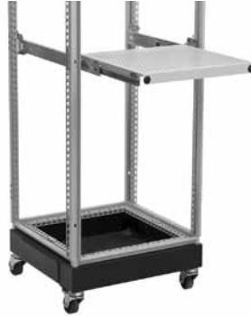
El estante deslizable para armazón permite fácil acceso a dispositivos montados en estantes. El estante es de acero calibre 16 con soportes de acero calibre 12. Todo el conjunto tiene acabado de pintura pulverizada de poliéster gris claro texturizado RAL 7035. El estante se monta en los postes verticales delanteros y traseros del armazón. La clasificación de carga es de 110 lb (50 kg).
