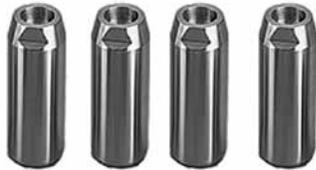
Las patas se montan en la parte inferior de una base sólida para elevar el gabinete 4 pulg. (100 mm) sobre el piso. Las patas están hechas de acero inoxidable tipo 304 y son apropiadas para aplicaciones con lavado a presión. Se incluyen los componentes para el montaje.
