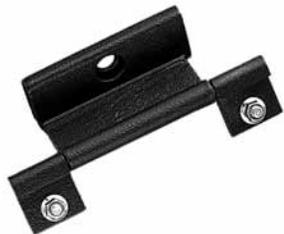
Bisagra opcional para puertas sólidas de acero, con ventana o de interruptores. Las bisagras de 180 grados proveen una apertura de puerta de hasta 260 grados en los gabinetes de un compartimento. Estas bisagras se montan en la brida de la puerta y tienen un aspecto de perfil bajo. El kit contiene tres bisagras con pintura pulverizada texturizada de poliéster negro y todos los componentes necesarios para el montaje. No puede usarse en puertas delanteras PROLINE® FLOTEK™ o CONNECTEK™.
