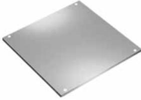
Las tapas superiores sólidas se utilizan para cerrar la abertura superior de un armazón de gabinete. Las tapas superiores de acero tienen acabado gris claro texturizado RAL 7035. Las tapas superiores sólidas EMC tienen acabado pintado sobre superficies chapadas. Las tapas superiores sólidas tienen empaques e incluyen terminales de conexión a tierra. Se incluyen pernos para sostener la tapa superior en su sitio (pueden usarse argollas de levantamiento en lugar de pernos).
