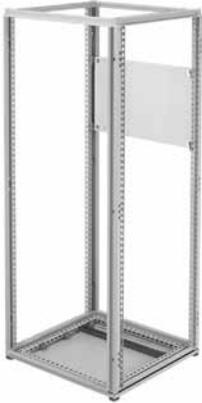
Los subpaneles parciales son de acero calibre 12, tienen bridas en cuatro costados y están pintados de color blanco. Los paneles pueden colocarse verticalmente en incrementos de 25 mm y también pueden colocarse a cualquier profundidad en incrementos de 25 mm usando las cintas para rejilla opcionales. Los subpaneles conductores son de acero galvanizado no pintado. Se incluyen todos los componentes necesarios para el montaje.
