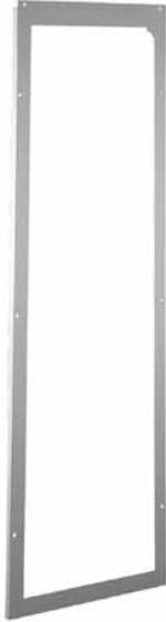
Los adaptadores para puerta lateral están hechos de acero calibre 14 con acabado de pintura pulverizada de poliéster gris claro texturizado RAL 7035. Permiten el montaje de una puerta estándar en el costado del gabinete. Al montarse en el gabinete, mantienen la integridad ambiental del gabinete.
