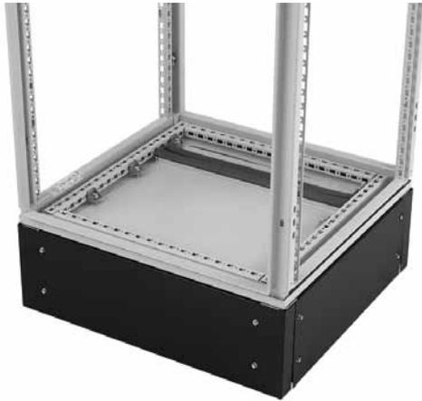
Las bases de solera se instalan debajo de un gabinete para proveer espacio para la entrada de cables por la parte inferior. Una base de solera consiste en ocho soportes de esquina conectados a cuatro paneles de acceso.
