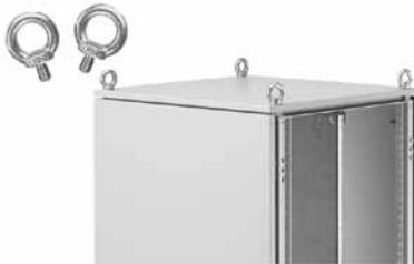
Las argollas de levantamiento se utilizan para levantar armazones modulares PROLINE® y para sujetar accesorios superiores PROLINE al armazón. Las argollas de levantamiento se enroscan en bloques de esquina en un armazón. Se proveen en juegos de cuatro unidades con acabado chapado.
