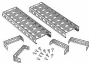
Las cintas de rejilla son de acero chapado calibre 14. Los orificios rectangulares de diseño especial permiten usar tuercas enjauladas o tuercas enjauladas de carga frontal. Los orificios de montaje se proveen con separación de 25 mm entre centros. Las cintas de rejilla están disponibles con una o tres filas de orificios y se entregan por pares. Se incluyen componentes de montaje para fijar las cintas de rejilla al armazón o a otras cintas de rejilla.
