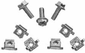
Se usan para sujetar componentes al sistema de rejilla. Los paquetes PGF contienen 20 tuercas de presilla de montaje frontal (M6) y 20 pernos con cabeza de arandela combinada (M6). El paquete de conexión a tierra se utiliza con los orificios rectangulares del armazón PROLINE® para establecer continuidad eléctrica entre el armazón y el sistema de rejilla. El paquete ASM5T se usa con los armazones PROLINE que tienen orificios redondos. El paquete contiene 20 tornillos autorroscantes M5.
