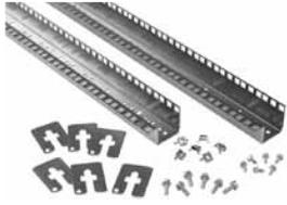
Los ángulos de rack de 23 pulg. están disponibles para aplicaciones de telecomunicaciones. Se montan directamente en armazones de 700 mm de ancho, o en armazones de 800 mm de ancho utilizando soportes reductores. Los ángulos de rack son de acero calibre 12 con agujeros roscados 10-32. Los ángulos de rack de 23 pulg. están disponibles con unidades de rack de 1.75 pulg. o con espaciado vertical de agujeros de 1.00 pulg.
