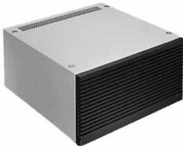
Los acondicionadores de aire de montaje superior sustituyen a la tapa superior sólida en un conjunto estándar. Los acondicionadores de aire no requieren el corte de orificios ni kits especiales para la instalación. Estos acondicionadores de aire están disponibles con capacidades de enfriamiento de 2200 y 4000 BTU/h y están equipados con un termostato ajustable para una regulación óptima de la temperatura del gabinete.
