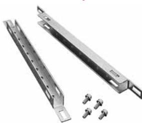
Las cintas se montan en la barra de la puerta. Se usan para montar accesorios a la puerta. Hechas de acero calibre 16 con acabado chapado. Sostienen hasta 100 lb (45.4 kg).
