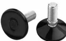
Cuatro niveladores de tipo poste que permiten realizar ajustes en pisos disperejos. Los niveladores pueden montarse en la parte inferior de un armazón o en una base sólida de 0 mm. Los niveladores están chapados y la base del nivelador tiene un tapón de plástico para brindar resistencia contra daños. Ajustable una altura de 17 mm a 35 mm. Construcción de rótula. Cuatro niveladores soportarán un peso máximo de 453.6 kg (1000 lb).
